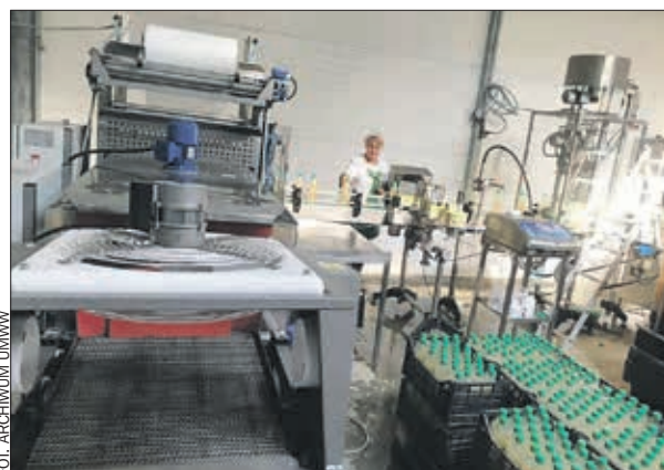
Nowa linia technologiczna w firmie STAN w Czajkowie pozwala na butelkowanie soków z kiszzonej kapusty i kiszonych ogórków, czyli produktów ubocznych kiszenia warzyw. Wpływa to na racjonalizację wykorzystania surowca. Inwestycja została zrealizowana dzięki dofinansowaniu ze środków LEADERA w ramach Programu Rozwoju Obszarów Wiejskich na lata 2014-2020.
